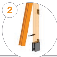
Guida a scatto e tappo “DIMA” Snap guide and “DIMA” plug
