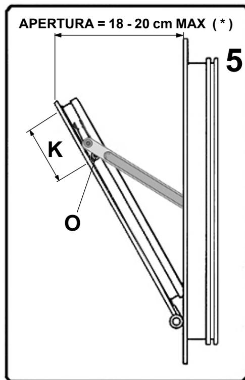
Posizionare l'ovalina di arresto (O) ad una distanza K da variare in funzione dell'apertura massima che si vuole ottenere. **Verificare che tutti e due i gommini-ammortizzatore dei bracci si fermino contro le ovaline.** (\*) In caso di montaggio con infissi particolarmente pesanti, diminuire l'apertura massima dell'anta.
