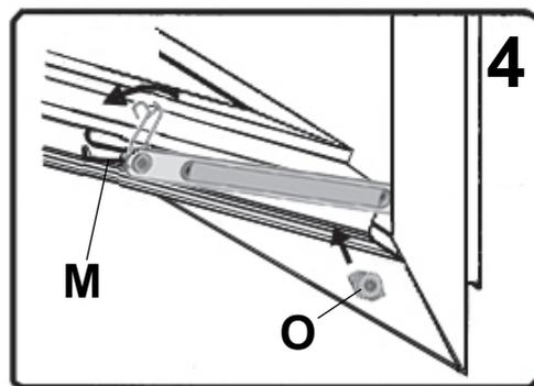
Ruotare la molla di bloccaggio (M) nella posizione indicata in Fig.4. **Verificare il corretto bloccaggio tra le alette della molla e la guida dell'anta.** Successivamente inserire l'ovalina di arresto (O) nella guida.
