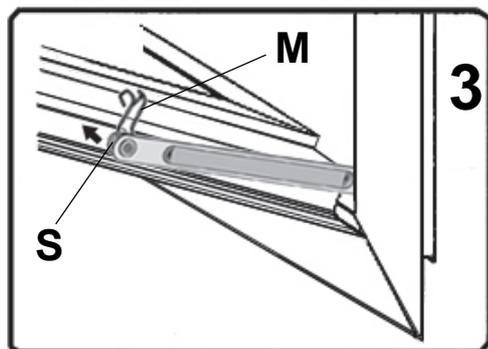
Introdurre il blocchetto scorrevole (Rif. S) nell'apposita guida dell'anta agendo sulla molla di bloccaggio (rif. M). **La posizione della molla dovrà essere come quella indicata in Fig. 3**
