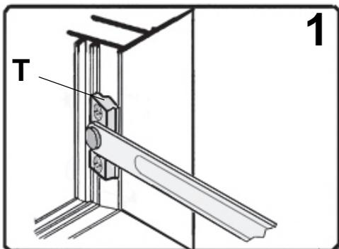
Introdurre il tassello (Rif. T) nell'apposita guida del telaio, inclinandolo come illustrato in Fig.1. (anche a infisso montato).
